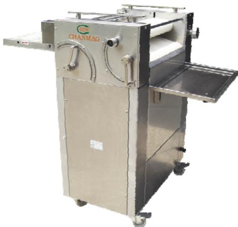
**CM-500B 可頌/羅宋整型機**，用於滿足羅宋與可頌麵團的特殊整型需求而設計。可搭配生產線使用時，可轉作為麵團二次整型增加緊實度的二次整型機；也可以配合不同的形狀麵團，整壓成為吐司多變化的不同形狀麵包成形。
